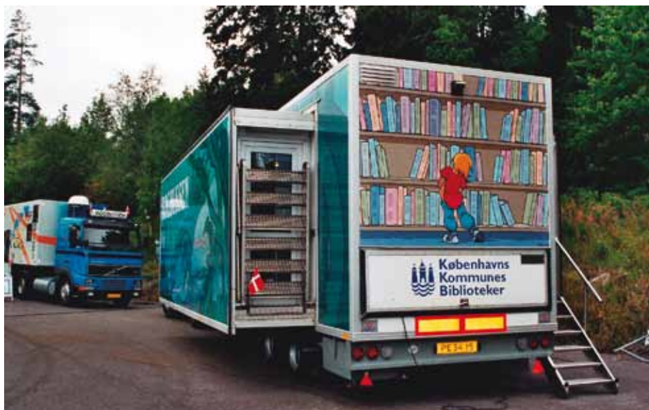
Semi-remolque con módulo retráctil en posición extendida. Copenhague, Dinamarca.
